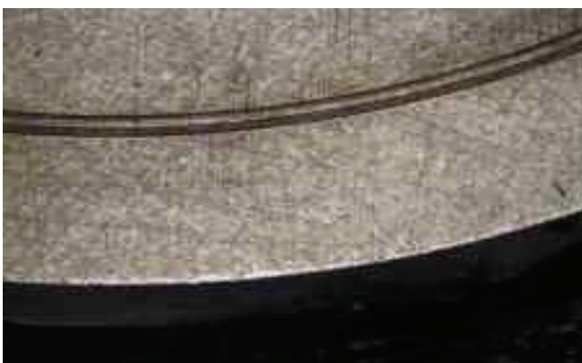
Einlaufrille nach 24 Stunden Run-in groove after 24 hours
