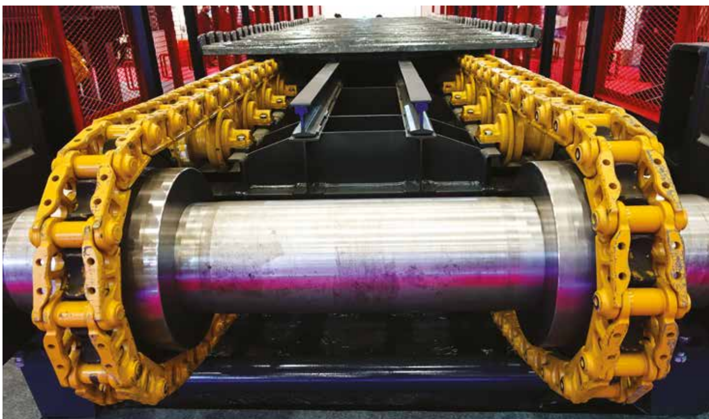
Bloccaggio delle ruote per catena in un trasportatore utilizzando SIT-LOCK® 4 COMPACT.
