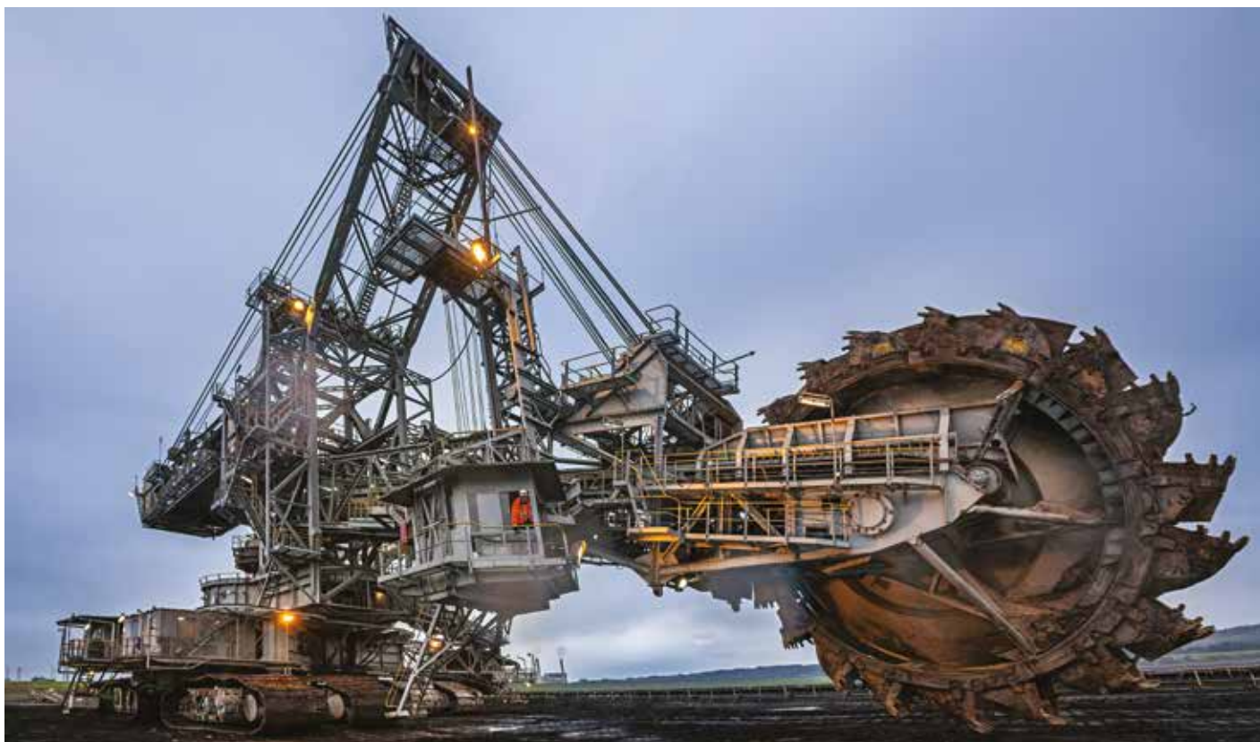
Applicazione su uno scavatore per miniera: SIT-LOCK® 4 COMPACT per i tamburi e SIT-LOCK® 14 per il bloccaggio della ruota a tazza.
