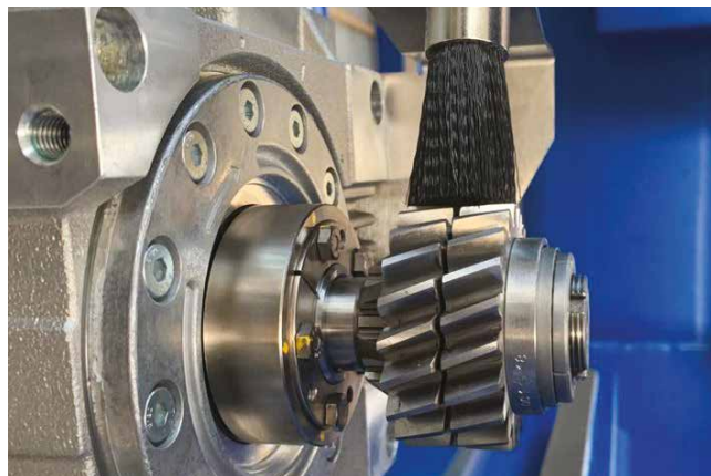
SIT-LOCK® 1422 applicato per il bloccaggio di un albero cavo.
