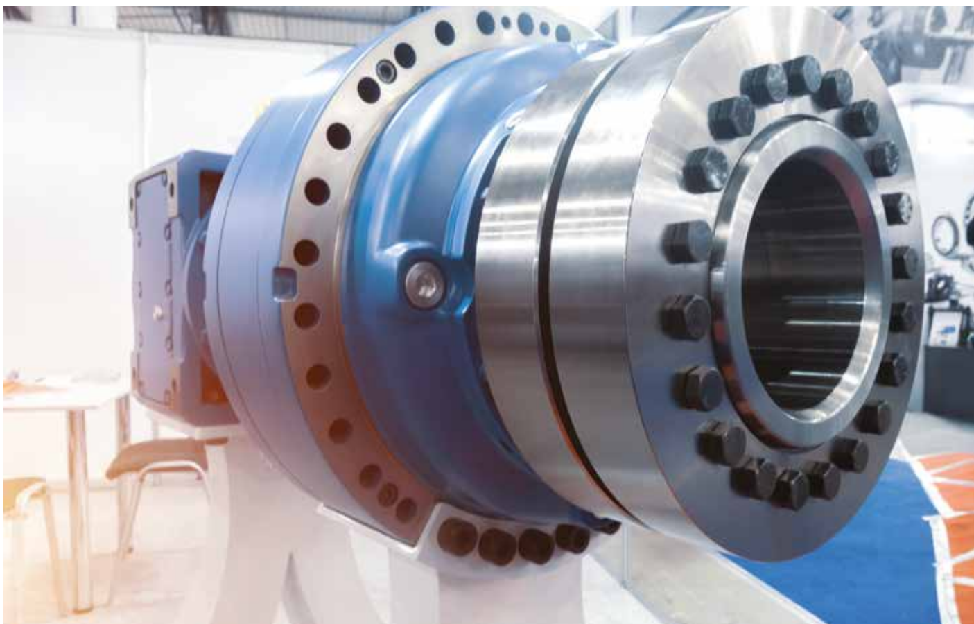
Bloccaggio dell'albero cavo di un riduttore epicicloidale tramite SIT-LOCK® 11.
